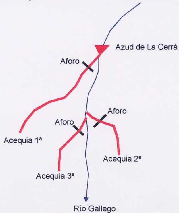
Figura 13.- Croquis de las secciones de aforo (Descarga del Manto de Blanquizares al río Gallego)
